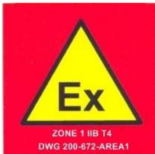
Figura 6 - Modelo de placa eficaz para sinalização de áreas classificadas.
